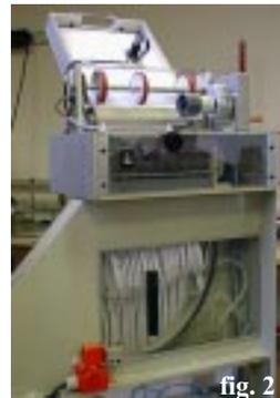
Après avoir placé les feuilles, remettre le chargeur en position incliné. Appuyer ensuite sur le bouton "Défaut" pour partir dans le cycle. Le chargeur opère alors de façon autonome, jusqu'à se vider. Une fois vide le message "Chargeur vide" apparaît sur le Magelis (seulement sur option terminal de dialogue) et le voyant défaut clignote. Procéder comme décrit ci-dessus pour recharger et repartir dans le cycle.
