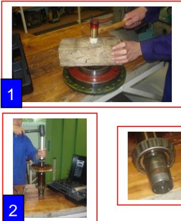
Placer les bagues extérieures des roulements dans les alésages des flasques en les frappant avec un tube ou un morceau de bois
