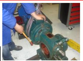
Sangler le stator avec une élingue et la mettre en tension grâce à la chèvre de levage
