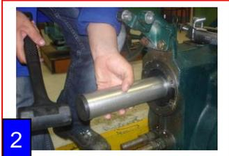
Replacer le roulement sur l'arbre du rotor avec un tube de diamètre de la bague intérieure
