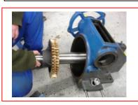
Remonter la roue dentée dans le support
