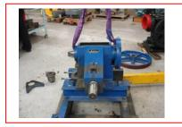
Remonter le support de la roue dentée sur le bâti puis fixer le support sur le bati
