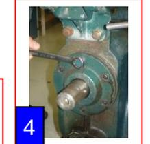
Replacer le flasque rotor provisoirement avec 4 vis
