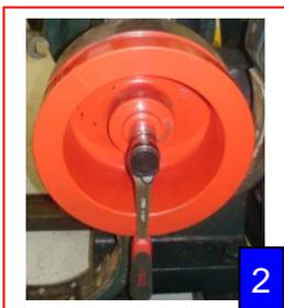
Repositionner la clavette et le volant d'inertie sur l'arbre
