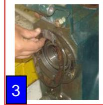
Replacer les 2 roulements dans l'alésage avec un tube de diamètre de la bague extérieure
