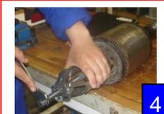
Frapper sur la cale à l'aide d'un tube (pour sortir les 2 roulements)
