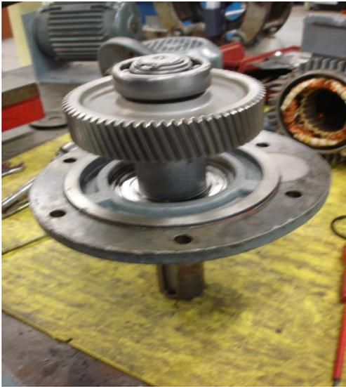
Remonter à l'aide d'un maillet le flasque et remonter le circlips intérieur à son emplacement
