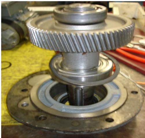
A l'aide d'une pince circlips retirer le circlips intérieur de l'arbre
