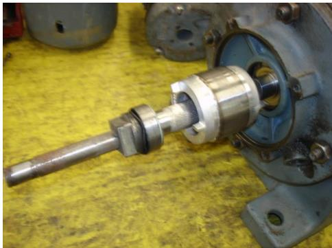
Dévisser les 4 écrous du support moteur du stator et le désolidariser à l'aide d'un gros tournevis et un maillet
