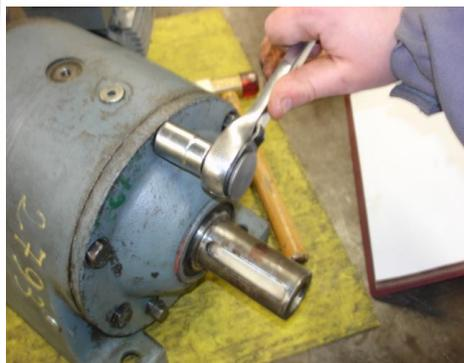
Desserrer et enlever les 8 vis de fixations du flasque avant du réducteur
