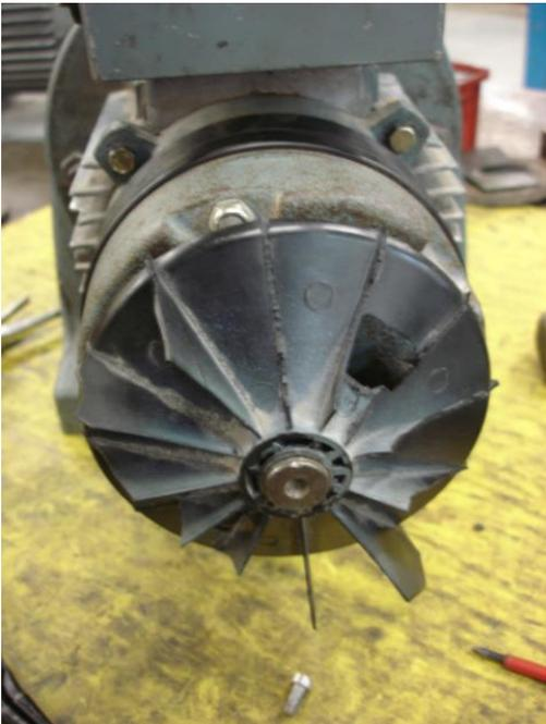
Remettre la clavette sur l'arbre et remettre l'hélice sur l'arbre en tapant légèrement avec un maillet n'oubliant pas de remettre le circlips
