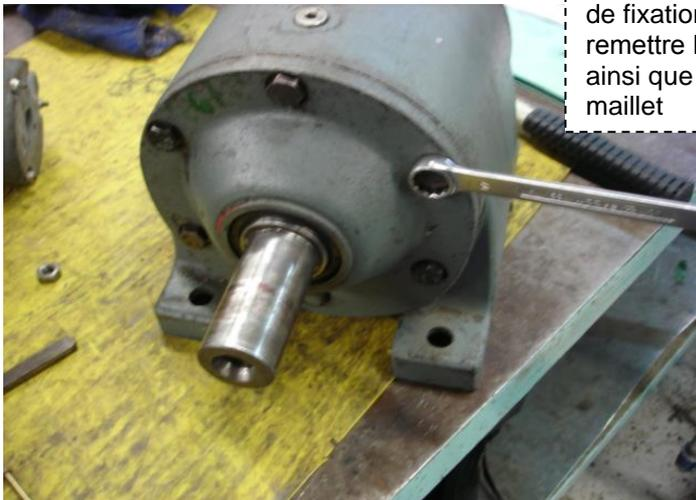
Remettre le sous-ensemble avec le flasque et remettre toutes les vis de fixation, sans oublier de remettre la rondelle sur l'arbre ainsi que la clavette à l'aide d'un maillet
