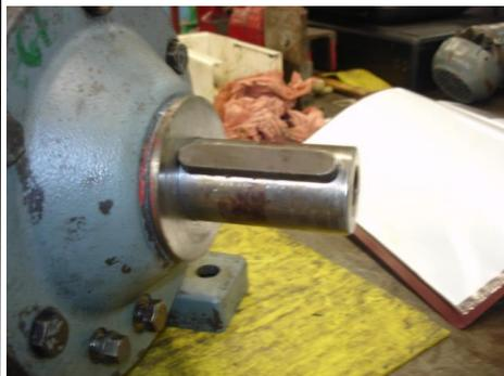
Décoller la clavette à l'aide d'un jet de bronze et d'un maillet si elle ne vient pas à la main et le retirer
