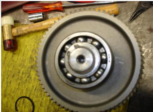
A l'aide d'une pince à circlips retirer le circlips extérieur de l'arbre
