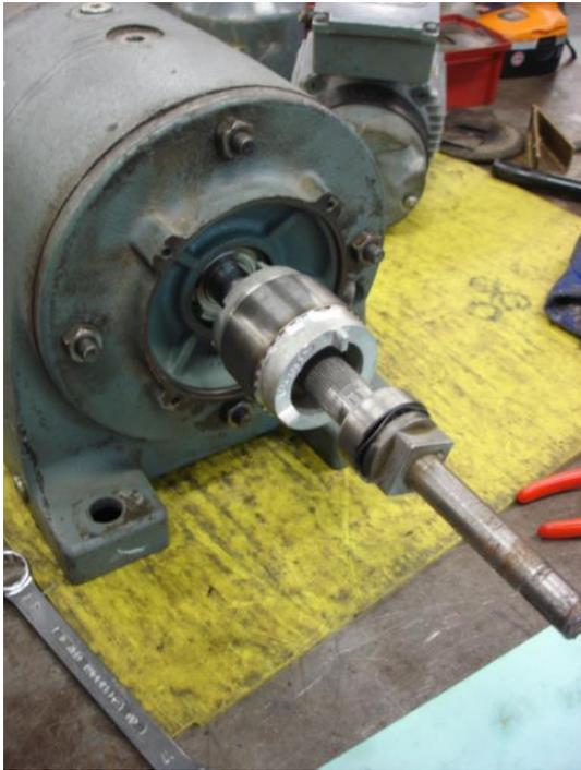
Remettre les 4 écrous du support moteur du stator
