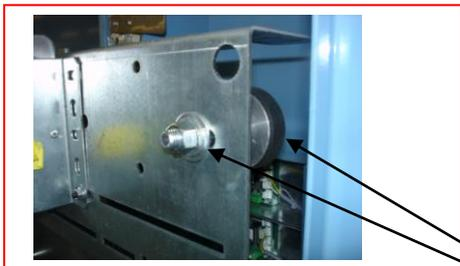
Repositionner la poulie tendeuse afin de bien tendre la courroie
