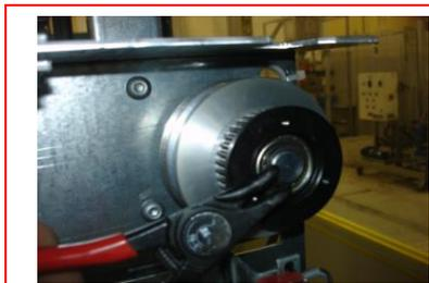
Remettre le circlips
