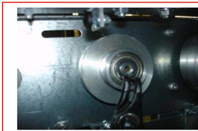
Remettre le circlips
