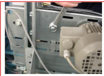
Desserrer la poulie intermédiaire afin de détendre la courroie de la poulie codeur
